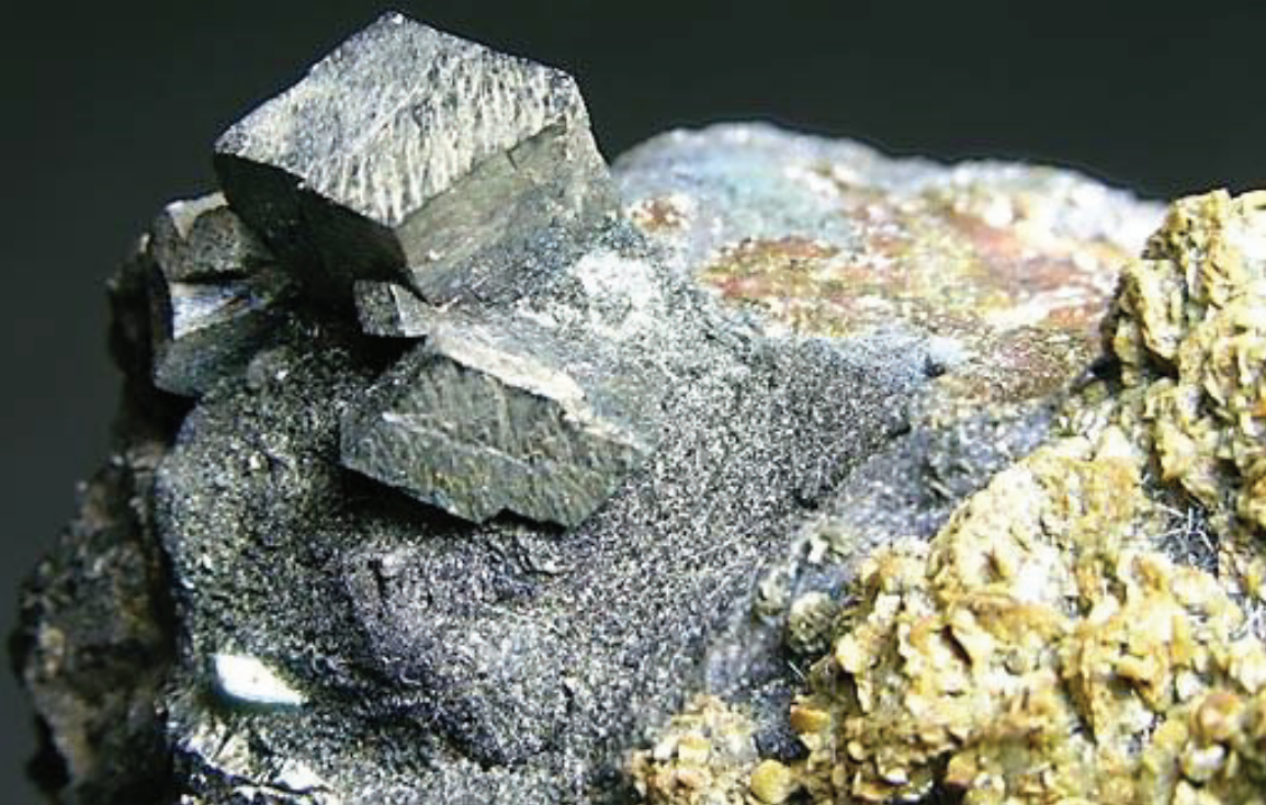
Kristale arsenopiriti mbi siderit me xhemsonit, lokaliteti: Miniera e Trepçës në Stantërg, Mitrovicë-Kosovë
